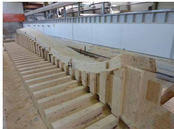
Abbildung 7: Toskana Therme Bad Orb: Erstellung zweifach gekrümmte Randbögen (Teilstücke)
