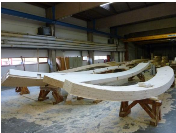
Abbildung 7: Toskana Therme Bad Orb: Erstellung zweifach gekrümmte Randbögen (Teilstücke)
