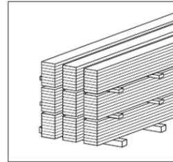
Unterleggehölzer und Stapellatten verwenden. Bauteile gegen Kippen sichern.
