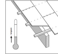
Rasche Dacheindeckung verhindert Durchfeuchtung und spätere Risse. Gebäude schonend trocknen (heizen). Abstand halten zwischen Wärmequelle und BSH-Bauteil.
