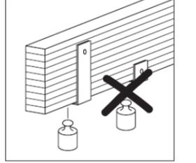
Aufnahme von zusätzlichen Lasten muss statisch nachgewiesen werden. Lasten oben einleiten. Querzug vermeiden.
