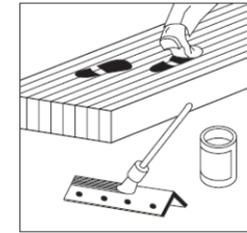
Verschmutzung z. B. durch Anstrich oder Abdeckung verhindern. Flecken von Imprägniersalzen und rostenden Stahlteilen vermeiden.
