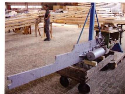
Bild 12 Federtopf des Gleitlagers an der Konsole mit Stahlschwert
