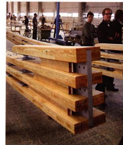
Bild 11 Jedes BS-Holz Brett besteht aus drei 2 cm dicken keilverzinkten Lamellen. Bei der Fertigung war eine hohe Genauigkeit gefordert – der ausführenden Holzbaufirma gelang eine dem Möbelbau vergleichbare Qualität.
