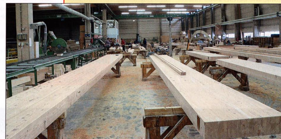
Lärchen-Leimbinder vor Einbringen der Bohrungen (Stand Januar 2006). Im Februar 2006 wurde hier das neue CNC-Portal-BAZ installiert
