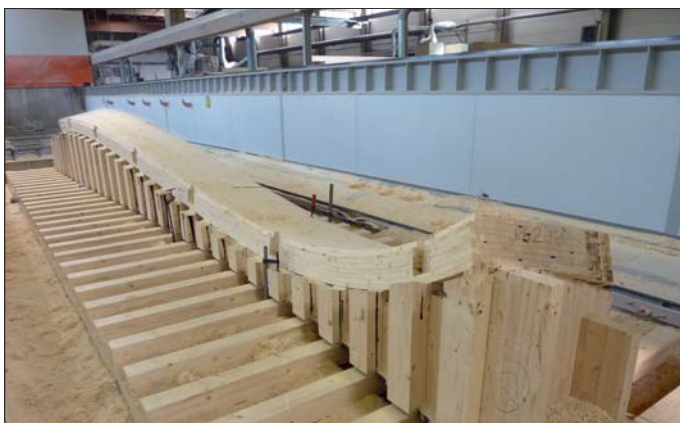
Erstellung der zweifach gekrümmten Randbögen (Teilstücke), Blockverleimung im selbst entwickelten Pressbett
