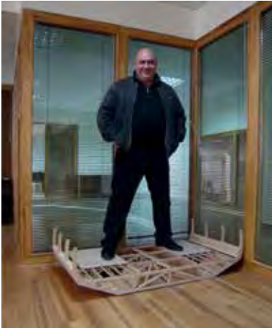
2 Alternativer Überbau: Hängebrücke »mit« Belastungstest © Leonhardt, Andrä und Partner AG
