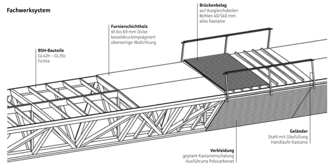
**STECKBRIEF** Neubau einer Holz-Stahlbrücke in Georgien504 **METER
