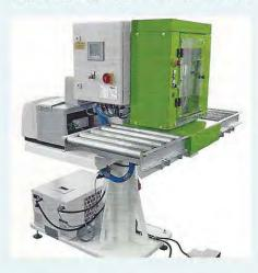
die Wintersteiger AG neu ein automatisches Spachtelsystem für Holzoberflächen an. Es nennt sich «TRC» (Timber Repair and Cosmetics). VAP Gruber übernimmt weiterhin die Produktion, die Maschinen werden aber durch Wintersteiger unter dessen Marke vertrieben.
