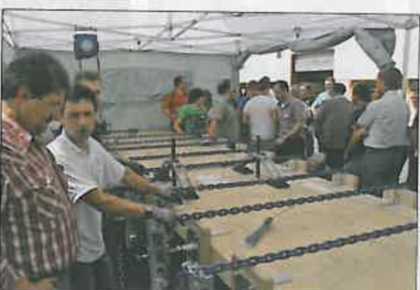
Die Schäftung wird an den Universal-Keilzinkenstoß angelegt (vgl. Foto links) und dann mittels eines Spannsystems aus Zugketten mit den beiden Brettschichtholz-Teilträgern verklebt.
