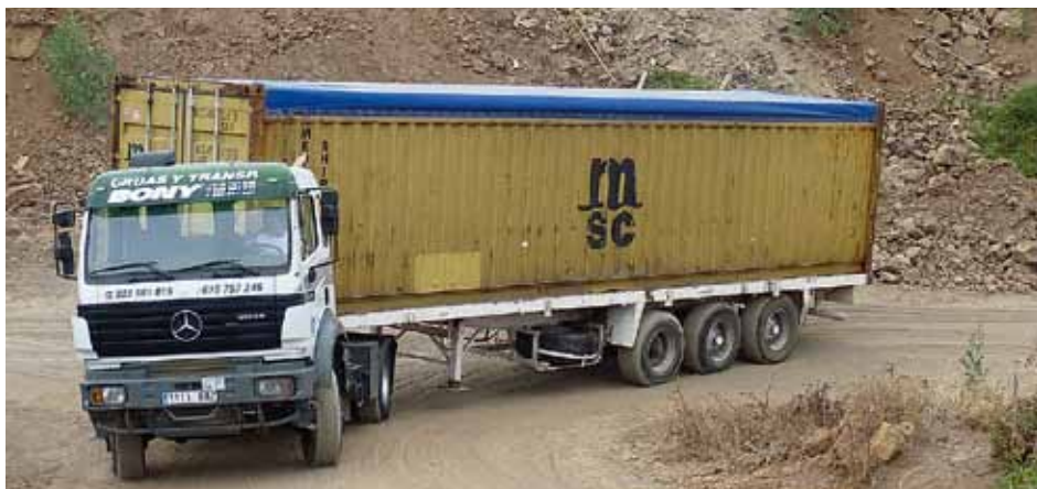
So werden vier 31 m lange BSH-Träger transportiert: Der Lkw rumpelt mit den Hess-Limitless-Einzelteilen im Container über die engen Schotterkurven in Teneriffa – undenkbar mit einem Schwertransport
